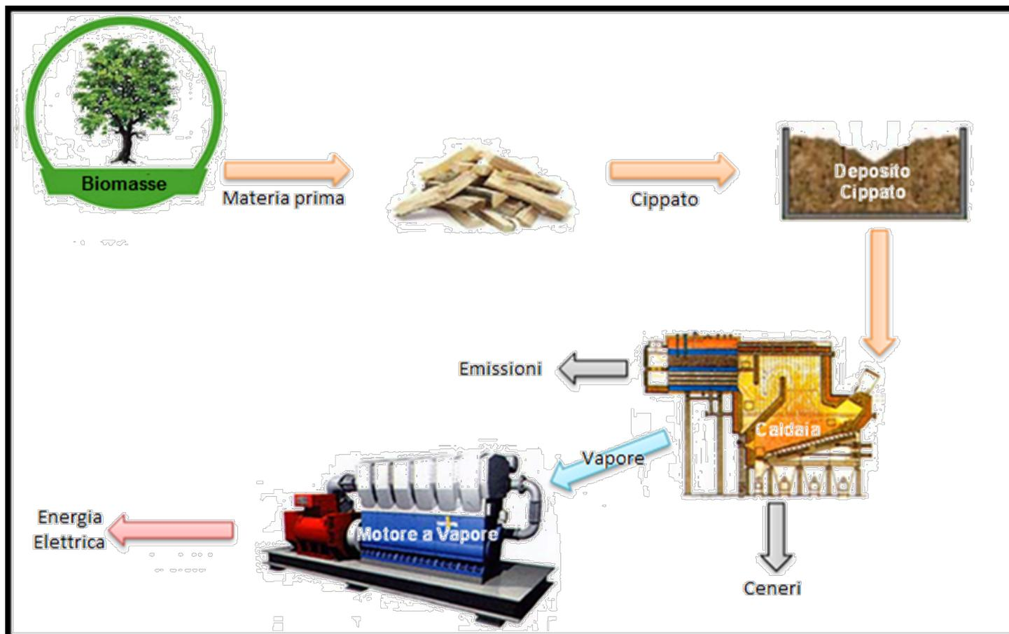
**VAP System** ha emissioni in atmosfera insignificanti, che provengono dalla combustione della materia prima in caldaia. Inoltre la linea di scarico dei fumi è dotata di un impianto di abbattimento delle emissioni.
